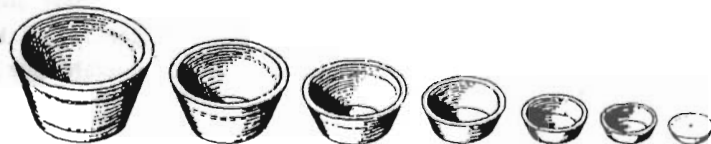
Gewichtssatz aus Messing, \frac{1}{2} Schw. Pfund (250 g) = 16 Lot Gehäuse = 8 Lot, Einsätze zu 4, 2, 1, \frac{1}{2} , \frac{1}{4} , \frac{1}{8} , \frac{1}{16} Lot, total = 16 Lot
