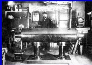
Abb. 8 Riesenduktor (120 cm Funkenstrecke) um 1901. Links unten: Induktor für gewöhnliche Röntgenstrahlen (Funkenstrecke 10 cm). Der Konstrukteur F.W. Klingelfuss, Klingelberg Basel, steht im Hintergrund.
